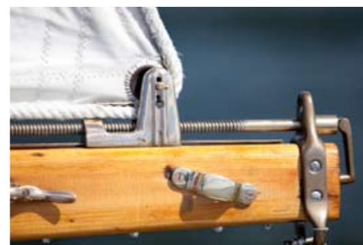
Alt. Der Kurbelspanner am Großsegel-Unterliek
